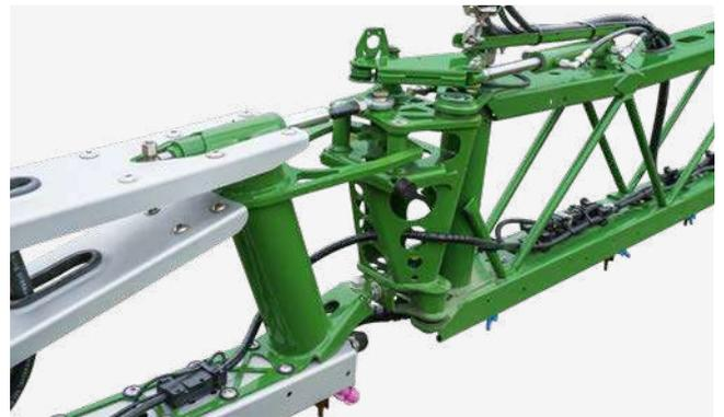
ブームエンドの油圧式ブレークバックシステム（サルーンのドア原理と同じ働きをする）は、後方、前方、上方からの障害物に対応し、作業位置への確実な復帰と長い耐用年数を保証します。
