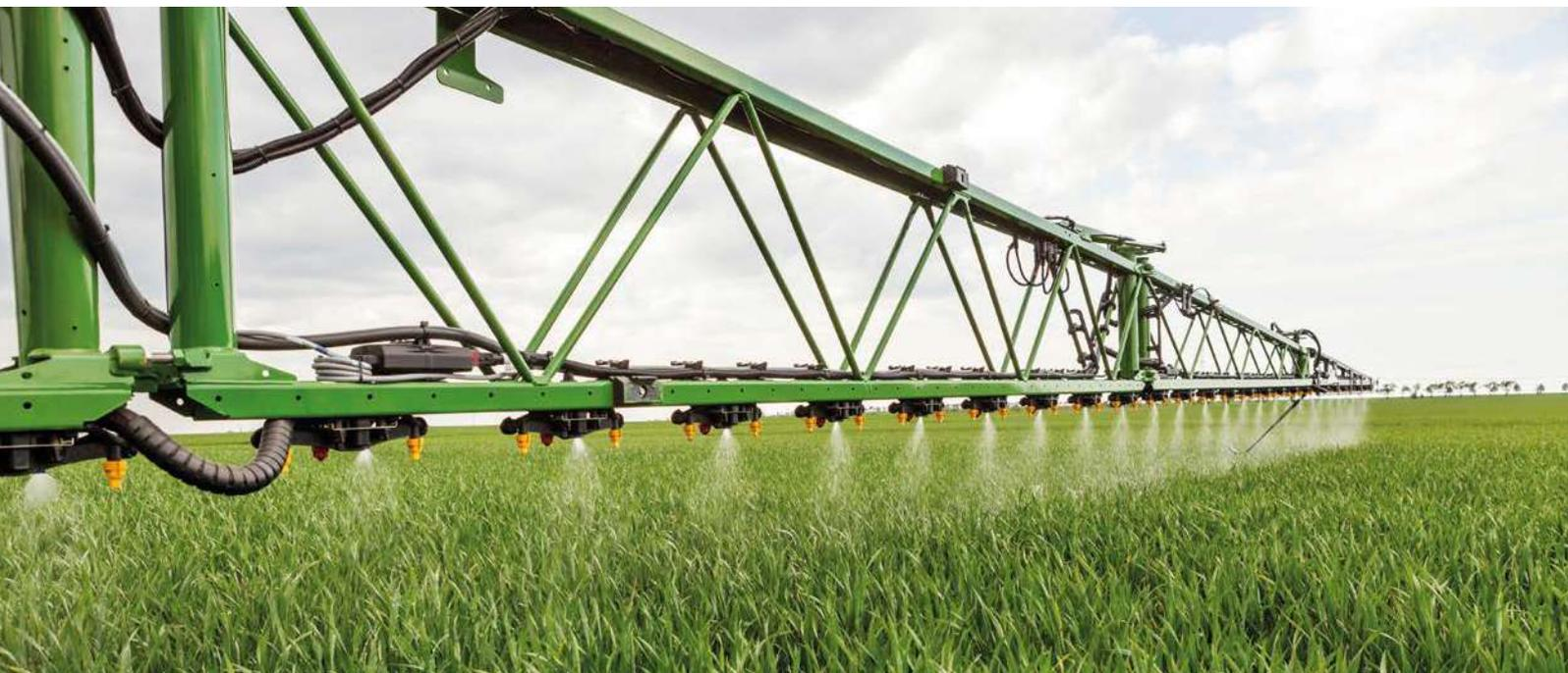
アマスイッチノズル・コントロール・システム、クワッドノズルボディ、Super-L2ブーム上のオフセットキットを使用したドラッグホース
