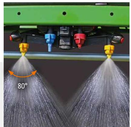
アマセレクト ノズルコントロール、クワッドノズルボディ、ノズル間隔50cmおよび25cm
