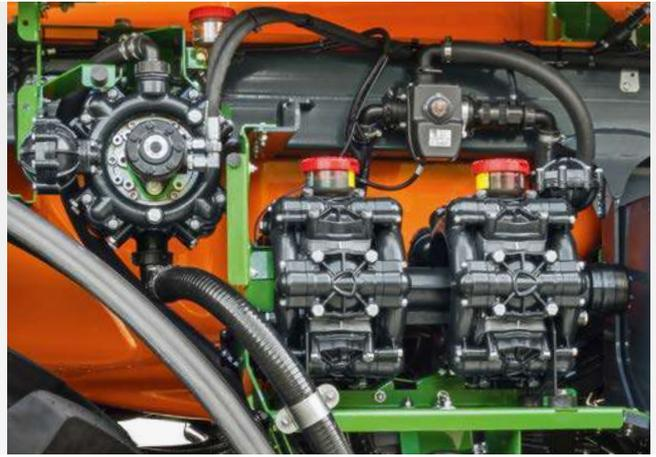
真水ポンプ(160 l/min)は、2台の強力なピストン・ダイアフラムポンプ(520 l/min)の隣に設置されている
