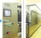
⑤ 炊飯・蒸し 強い火力の最新炊飯器を採用。釜の中いびいご飯になり、炊きムラが起き上がります。生産能力を誇りの中で30分間蒸しで炊飯を完了。蒸らしセッティングしながら、安定し管理します。
