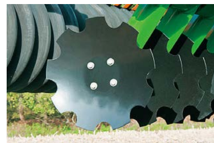
カトロスプラスディスク:厚さ5mm、直径51cm
