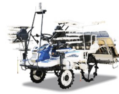
さなえPRJ8ロボット田植機 （有人監視型）
