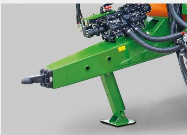
便利な油圧式高さ調節機能により、トラクターへの連結が素早く、簡単に行えます。
